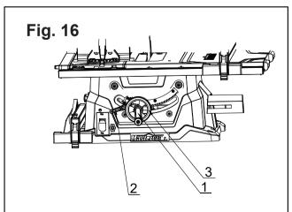
**WARNING:** THE BLADE BEVEL LOCKING KNOB (2) MUST BE TIGHTENED SECURELY AND LOCKED DURING ALL CUTTING OPERATIONS..
