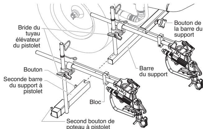
**NOTA :** La barre du support à pistolet et le pistolet pulvérisateur peuvent être montés d'un côté ou de l'autre du pulvérisateur. Consulter l'illustration « position du pulvérisateur » près de la partie arrière du présent manuel.
