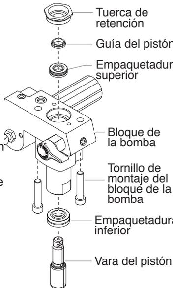
Instale la empaquetadura superior con el reborde levantado puntado hacia abajo.
