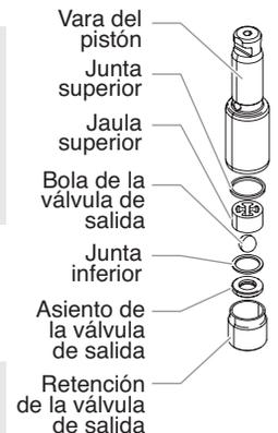
5. Retire, limpie e inspeccione la jaula de salida y la bola de la válvula de salida. Reemplácelas si están gastadas o dañadas.
