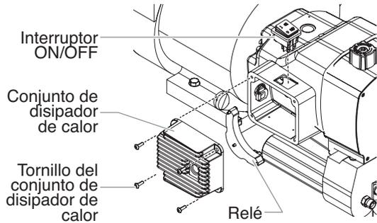
4. Desconecte los cables del interruptor desde el interruptor ON/OFF del pulverizador. Recuerde las ubicaciones de ambos cables (etiquételos si fuese necesario).
