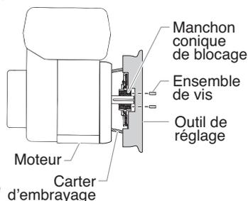
resserrer les vis dans le manchon conique fendu. Régler le couple entre 65 et 75 po-lb.
