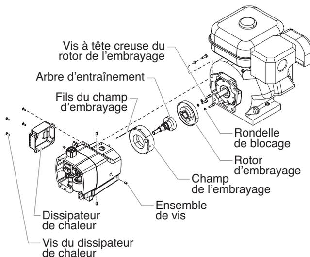
**NOTA : Avant de démonter l'arbre d'entraînement, il faut d'abord démonter le corps de la pompe du carter d'engrenage.**
