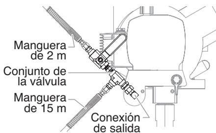
3. Conecte una pistola de pulverización sin aire en cada una de las mangueras de pulverización. Con dos llaves (una en la pistola y otra en la manguera), apriete hasta que quede firme.
