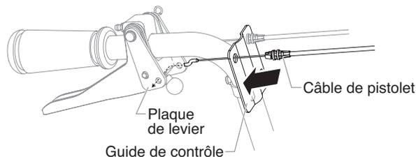
**NOTA :** Voir la section « Régler la tension de la détente » afin de vérifier si le câble est installé correctement.
