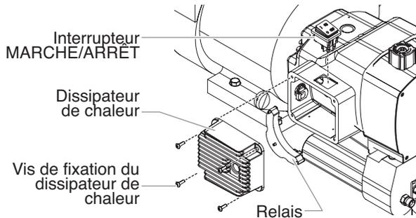
4. Déconnecter les fils de l'interrupteur du pulvérisateur. Ne pas oublier l'emplacement de chacun des deux fils (les marquer avec des étiquettes, au besoin).
