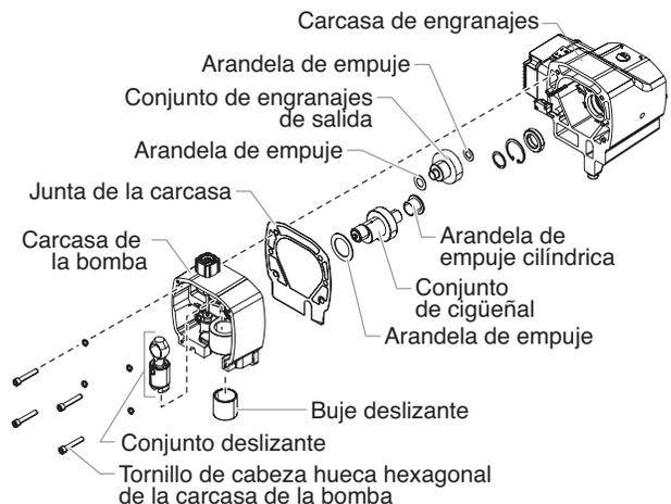
9. Deslice la carcasa de la bomba lejos de la carcasa de engranajes.
