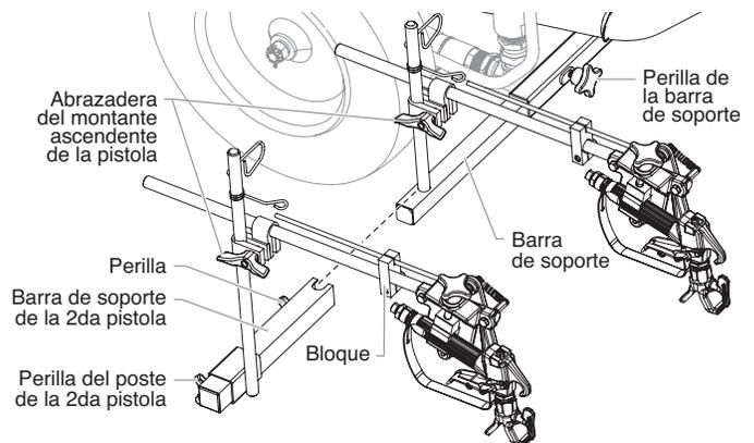
**NOTA:** La barra de apoyo de la pistola y la pistola pulverizadora se pueden montar en cualquier lado del pulverizador. Consulte la ilustración "Posiciones de la pistola de pulverización" cerca del reverso de este manual.
