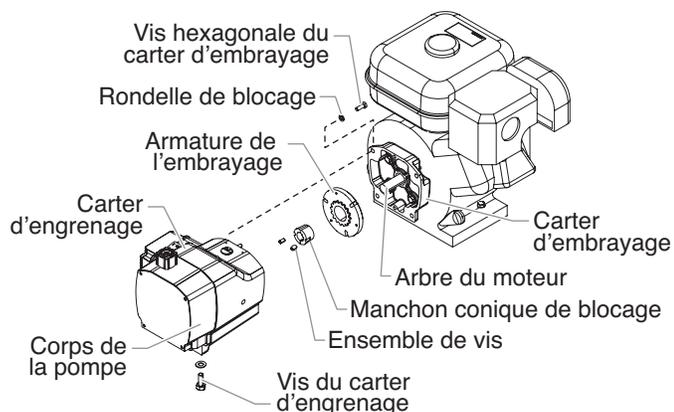
6. Repérer l'armature de l'embrayage à l'extrémité de l'arbre du moteur. Remarquer les deux ensembles de vis et l'orifice fileté, inoccupé du manchon conique fendu au centre du moyeu d'embrayage.
