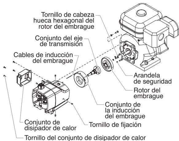
**NOTA: Para sacar el conjunto del eje de transmisión, primero se debe sacar la carcasa de la bomba desde la carcasa de engranajes.**
