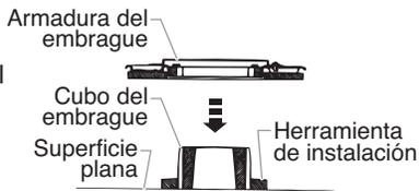
**NOTA: Un nuevo cubo del embrague y armadura del embrague se pre-ensamblados, por el "retroceso" pueden no ser correctos. El "retroceso" debe ser creado utilizando la herramienta de instalación.**
