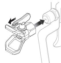
**NOTA:** La flecha en la pieza de sujeción de la boquilla debe apuntar hacia delante para pulverizar.
