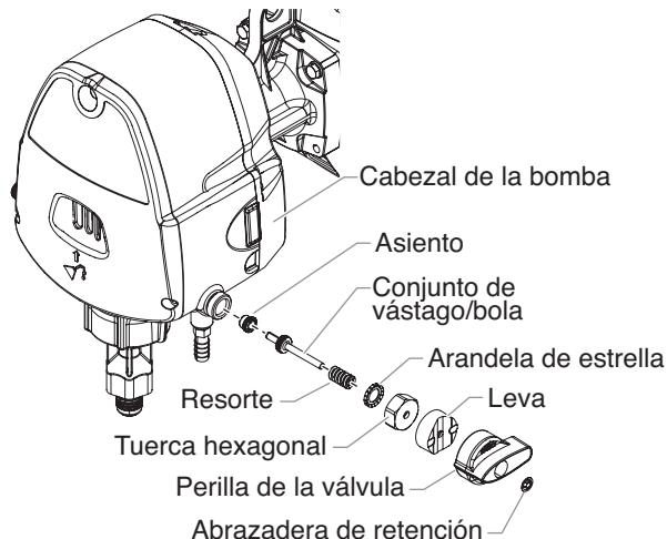
6. Apriete el nuevo asiento del conjunto de vástago/bola en el cabezal de la bomba. Use una llave hexagonal de 7/32 pulgadas. Apriete de 6 a 8 lb-pies.
