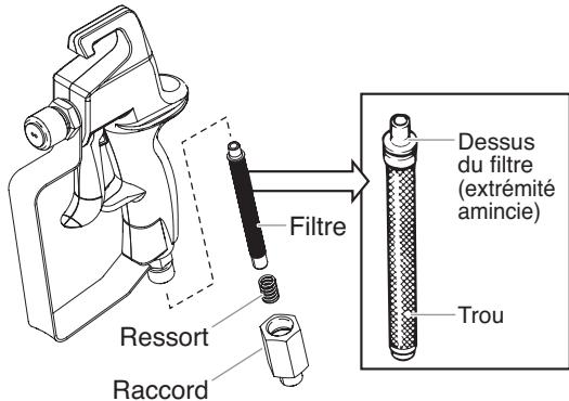
**NOTA :** Ne jamais piquer le filtre au moyen d'un instrument pointu.
