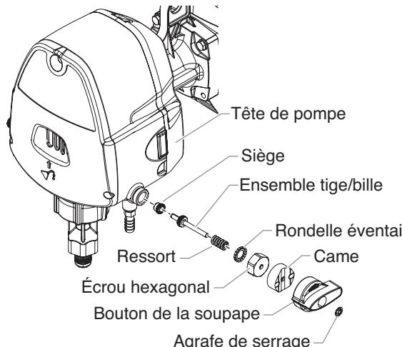
6. Resserrer le nouveau siège de l'ensemble tige/bille dans la tête de pompe. Utiliser une clé à tête hexagonale de 7/32 po. Serrer à un couple de 6 à 8 pi-lb.
