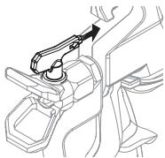
**NOTE:** Si cuesta girar la punta de pulverización, libere presión al 1) girar lentamente la perilla PRIME/SPRAY hasta la posición PRIME, 2) desbloquear la pistola de pulverización y 3) apretar el gatillo mientras apunta hacia un pedazo de material o cartón. Suelte el gatillo, bloquee la pistola de pulverización e intente girar nuevamente la boquilla de pulverización.
