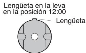
13. Coloque la nueva perilla de la válvula PRIME/SPRAY sobre la leva con el indicador en la perilla lo más cerca posible de la posición de las 9:00. Asegúrese de que la perilla esté presionada completamente al interior de la leva (la perilla debe cubrir completamente la leva).
