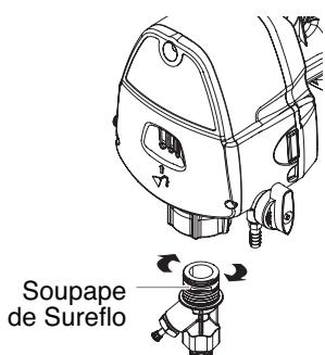
**NOTA :** Si le problème d'amorçage persiste, vous pouvez devoir remplacer le soupape de Sureflo. Appelez le Service technique pour commander un nouveau soupape de Sureflo.
