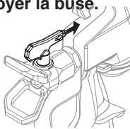
**NOTA :** S'il est difficile de tourner la buse de pulvérisation, diminuez la pression 1) en tournant lentement le soupape PRIME/SPRAY à PRIME, 2) en débloquant le pistolet pulvérisateur et 3) en appuyant sur la détente tout en pointant vers des débris/morceaux de carton. Relâchez la détente, bloquez le pistolet pulvérisateur, et faites tourner la buse de pulvérisation de nouveau.
