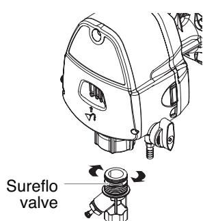
**NOTA:** Si continúa teniendo problemas de imprimación, tal vez deba reemplazar el ensamblaje de la válvula de entrada. Llame al Servicio Técnico para pedir un nuevo ensamblaje de válvula de Sureflo.
