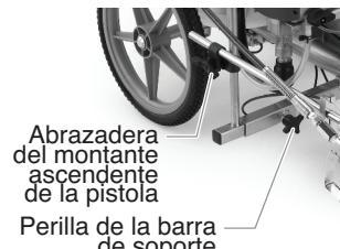
**NOTA:** La altura de la pistola pulverizadora afecta el ancho del patrón de pulverización (es decir, mientras más abajo esté la pistola, más pequeño será el ancho de la línea). El tamaño de la punta también afecta el ancho de la línea.
