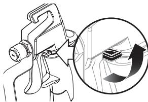
**NOTA :** Si nécessaire, desserrez le bouton de ensemble de support à pistolet, puis engager le verrou de détente. Déplacez le pistolet à la position initiale et serrez le bouton de la ensemble de support à pistolet.
